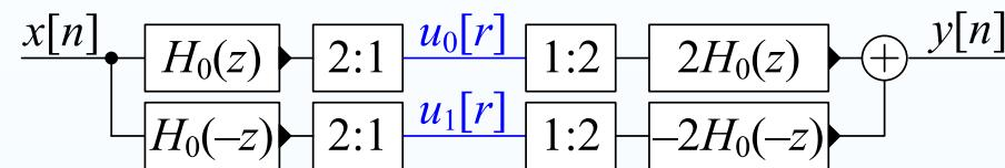
$H_0(z)$  order  $M$ , linear phase  $\Rightarrow H_0(e^{j\omega}) = \pm e^{-j\omega \frac{M}{2}} |H_0(e^{j\omega})|$
